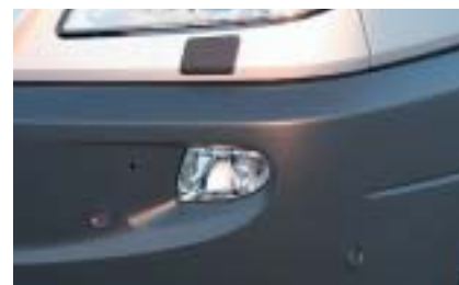
Die breitflächigen Stoßfänger sind Teil des geschraubten Frontmoduls.
