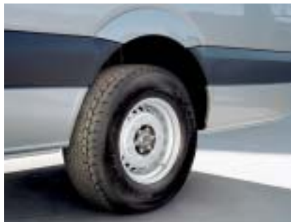
Ein Supersingle für den 4,6-Tonner spart Gewicht und Rollwiderstand.
