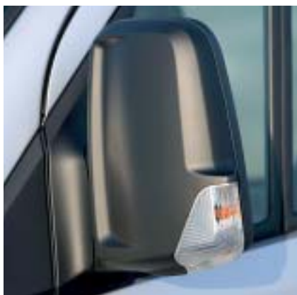
Die Seitenblinker zwinkern nun aus dem Gehäuse des Außenspiegels.
